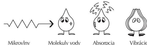
Mikrovlny spôsobujú vibráciu molekúl vody, čo spôsobuje TRENIE, teda TEPLA. Toto teplo potom ohrevia pokrm.
