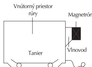
V mikrovlnnej rúre je elektrina konvertovaná na mikrovlny pomocou MAGNETRÓNOM.
