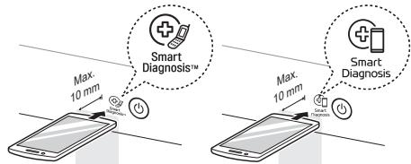
**3** Po dobu 3 sekúnd alebo dlhšie stlačte a podržte tlačidlo **Teplota** a zároveň držte náustok smartfónu pri logu, kým sa prenos dát neskončí.
