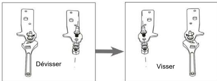
9. Installez la charnière sur le côté gauche et le pied sur le côté droit. Vissez ensuite deux pieds de nivellation avec leurs pièces d'origine.
