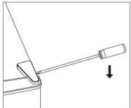
2. Desenrosque la bisagra superior con un destornillador Phillips.
