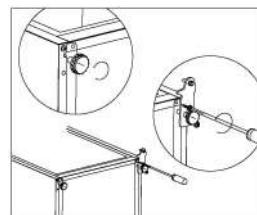
8. Suelte y retire el pasador de la bisagra inferior; dele la vuelta a la bisagra y vuelva a colocarla.
