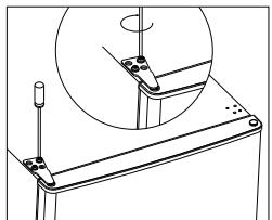
14. Ponga la tapa de la bisagra y la tapa del orificio en la parte superior de la unidad.
