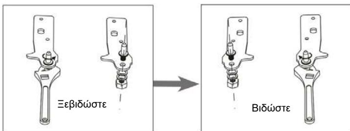
9. Τοποθετήστε τον μεντεσέ στην αριστερή πλευρά και τη βάση ποδιού στη δεξιά πλευρά. Στη συνέχεια, βιδώστε δύο πόδια αλφαδιάσματος με τα αρχικά μέρη τους.
