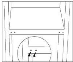
7. Posez l'arrière de l'appareil sur une surface rembourrée. Dévissez la charnière inférieure et le pied de nivellement.
