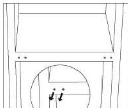
11. Levante la unidad y coloque la puerta en la bisagra inferior. Asegúrese de que el núcleo de la bisagra inferior esté insertado en el orificio de la puerta. A continuación, mueva la tapa del orificio de la bisagra de la puerta inferior del lado izquierdo al lado derecho.
