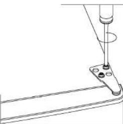
3. Uklonite poklopac otvora ravnim odvijačem.
