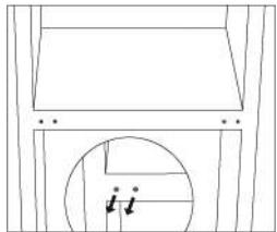
7. Túmbese en la parte trasera del armario sobre una almohadilla blanda. Desenrosque la bisagra inferior y la pata de nivelación.
