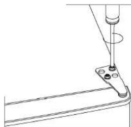
3. Retire la tapa del orificio con un destornillador plano.
