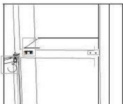
13. Namontujte horní dvere s horním závěsem.
