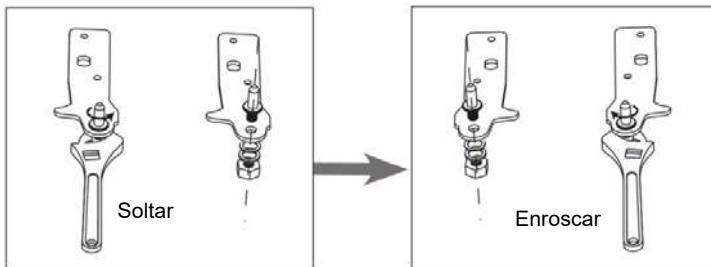
9. Instale la bisagra en el lado izquierdo y la base de la pata en el lado derecho. A continuación, atornille las dos patas de nivelación con sus piezas originales.
