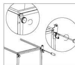
8. Ξεβιδώστε και αφαιρέστε τον πείρο του κάτω μεντεσέ, περιστρέψτε το στήριγμα και τοποθετήστε το ξανά.
