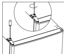
14. Zavakněte kryt závěsu a kryt otvoru v horní časti jednotky.
