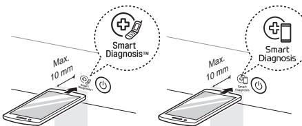
**3** Stiskněte a podržte tlačítko **Teplota** po dobu 3 sekund nebo déle a náustek smartphonu mezitím držte u loga, dokud není přenos dat dokončen.
