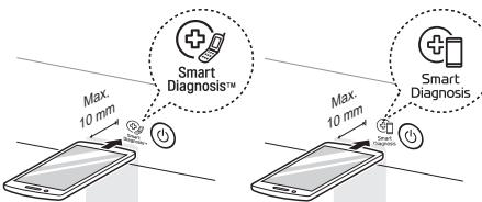
**3** Po dobu 3 sekúnd alebo dlhšie stlačte a podržte tlačidlo **Teplota** a zároveň držte náustok smartfónu pri logu, kým sa prenos dát neskončí.
