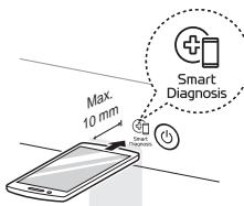
**3** Po dobu 3 sekúnd alebo dlhšie stlačte a podržte tlačidlo **Teplota (Teplota)** a zároveň držte náustok smartfónu pri logu, kým sa prenos dát neskončí.
