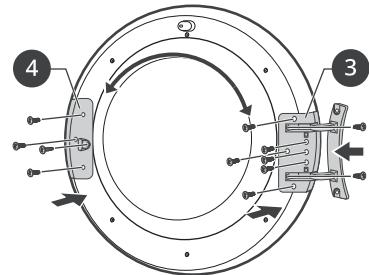
**5** Odstraněním 2 šroubek sundejte uchycení dvířek **5** z rámu spotřebiče a poté ho namontujte na opačnou stranu.
