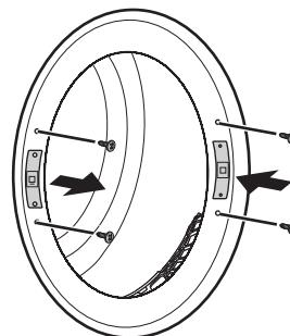
**7** Nainstalujte dvířka pomocí šroubek odstraněných v kroku č. 1 a poté
