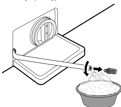
**4** Pomalu odšroubujte filtr odtokového čerpadla a vypusťte zbývající vodu a poté odstraňte z filtru veškeré nečistoty nebo předměty.
