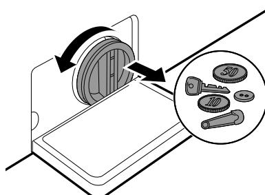
**5** Po vyčištění filtru odtokového čerpadla znova vložte filtr a opatrně zašroubujte odtokový uzávěr zpět ve směru hodinových ručiček, abyste zabránili nesprávnému zakroucení a úniku vody. Znovu zasuňte uzávěr zpět do odtokové trubky a vložte trubku do držáku.
