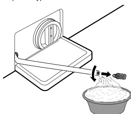
**4** Pomaly odskrutkujte filter vypúšťacieho čerpadla a vypustite zvyšnú vodu a potom
