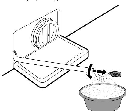
**4** Pomalu odšroubujte filtr odtokového čerpadla a vypusťte zbývající vodu a poté odstraňte z filtru veškeré nečistoty nebo předměty.
