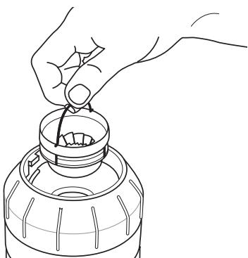
5. Vyčistite horný mlecí kameň pomocou dodávanej čistiacej kefky.
