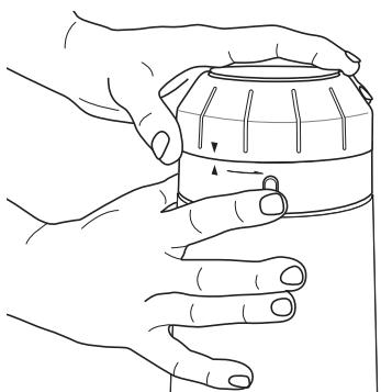
4. Stále držte tlačidlo UNLOCK stlačené a druhou rukou zdvihnite horný mlecí kameň za rukoväť a vyberte ho smerom hore – pozrite obrázok nižšie. Uvoľnite tlačidlo.
