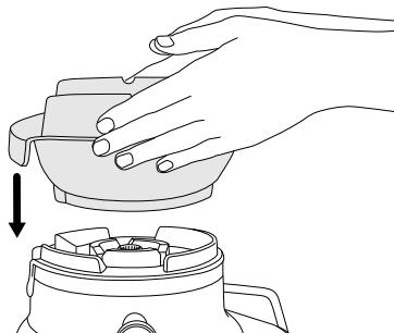
2. Zarovnajte šípky na spodnej časti antikorového sita so šípkami na hriadele motoru a pritlačte sito na hriadeľ, až začujete cvaknutie, aby ste bezpečne zaistili antikorové sito na motorovú základňu.
