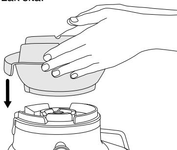
2. Zarovnejte šípky na spodní části nerezového síta se šípkami na hřídele motoru a přitlačte síto na hřídel, až uslyšíte cvaknutí, abyste bezpečně zajistili nerezové síto na motorovou základnu.
