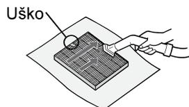
Pomocou príslušenstva k vysávaču alebo podobného nástroja jemne odstráňte prach z HEPA FILTRA a deodorizačného filtra.
