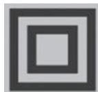
Toto zařízení je chráněno dvojitou izolací. Vždy zkontrolujte, zda síťové napětí odpovídá napětí na typovém štítku.
