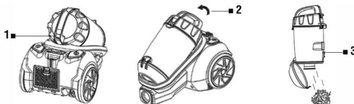
3. Entriegeln Sie den Schmutzbehälter durch Drücken der Entriegelungstaste ( 1 ). Heben Sie den Behälter vom Staubsaugergehäuse ab ( 2 ). Drücken Sie die Taste zum Öffnen ( 3 ), der Boden des Behälters öffnet sich und der Staub fällt in den Abfallbehälter.
