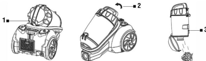
1. Deblocați rezervorul de impurități prin apăsarea butonului de deblocare (1). Scoateți rezervorul din corpul aspiratorului (2). Apăsați butonul pentru deschiderea rezervorului (3), baza acestuia se deschide, iar praful cade în coșul de gunoi.
