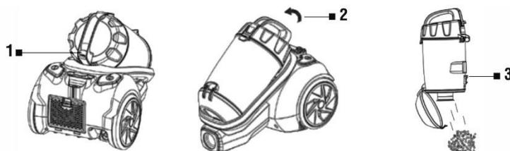
1. Zwolnij pojemnik na śmieci, naciskając przycisk zwalniający (1). Wyjmij zbiornik z korpusu odkurzacza (2). Naciśnij przycisk, aby go otworzyć (3), podstawa pojemnika otworzy się i kurz wpada do śmiertnika.
