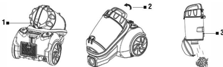
1. Uvoľnite zásobník na nečistoty stlačením uvoľňovacieho tlačidla (1). Zdvíhnite zásobník z tela vysávača (2). Stlačte tlačidlo na jeho otvorení (3), základňa zásobníka sa otvorí a prach spadne do odpadkového koša.
