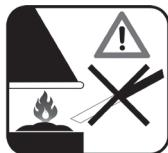
Nevysávejte žhavé uhlíky, hořící předměty, předměty přesahující teplotu  $40^{\circ}\text{C}$  ( $104^{\circ}\text{F}$ ).
