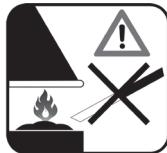
Nevysávajte žeravé uhlíky, horiace predmety, predmety presahujúce teplotu  $40\text{ }^{\circ}\text{C}$  ( $104\text{ }^{\circ}\text{F}$ ).
