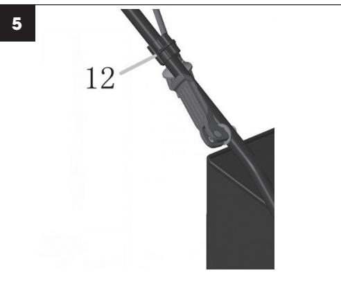
5. Vložte kovový rám ⑩ do látkového sběrného koše ⑨ a připevněte všechny příchytky na levou, pravou a zadní tyč rámu. Ujistěte se, že jsou všechny příchytky správně zajištěné (obr. 6).
