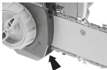
Zachycovač řetězu slouží k tomu, aby zachytil přetržený nebo spadlý řetěz. Takovýmto nehodám lze předcházet pravidelnou údržbou řezací lišty a správným a pravidelným napínáním pilového řetězu.
