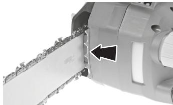
A karmos ütköző húzó fűrészelés esetén lehetővé teszi a motorblokknak a fán történő rögzítését. Ezáltal kisebb az esélye a fűrész kontrollálatlan visszacsapódásának. Emellett a létrejövő karhatás segítségével nyomást lehet kifejni a fűrészláncra.
