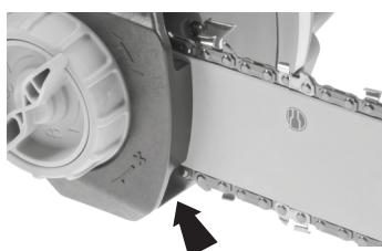
Wychwytnik łańcucha służy do wychwycenia przerwanego lub zsuniętego z rowka łańcucha. Tego typu wypadkom można przeciwdziałać poprzez regularną konserwację prowadnicy, a także właściwe i regularne napinanie łańcucha.
