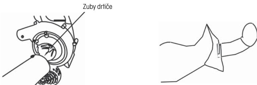
Otevřete kryt ventilátoru, připojte sací trubku č. 1 a č. 2
