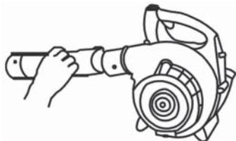
Umístěte foukací trubku B do stroje otáčením
