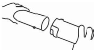
Włóż dmuchawę B do urządzenia, obracając ją
