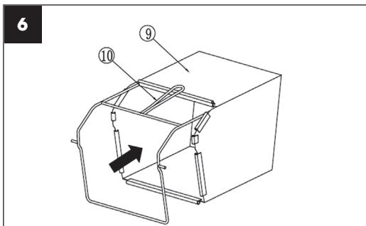
6. Montáž zcela sestaveného sběrného koše na vertikutátor (obr. 7).
