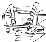
Seřízení proudu oleje pro mazání řetězu
